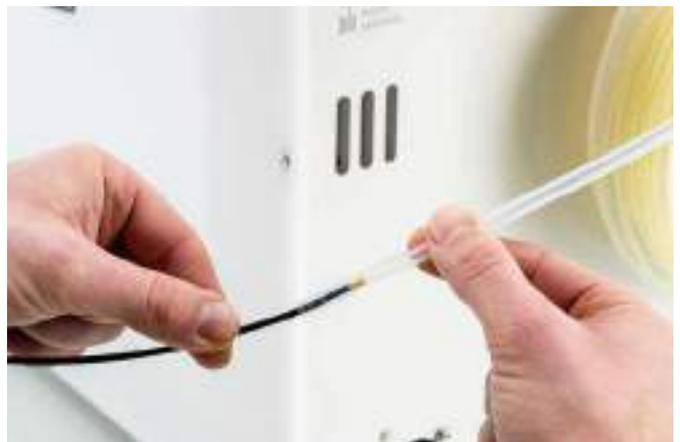
7. Insérez le tube Bowden dans le chargeur en appuyant sur la pince de serrage du tube dans le chargeur et en enfonçant le tube Bowden jusqu'au bout. Attachez le tube avec l'étrier de fermeture. Répétez cette opération pour l'autre tube Bowden.
