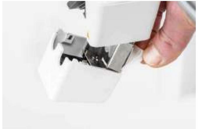
5. Poussez la languette avant à travers la fente du support de ventilateur de la tête d'impression, tout en appliquant une pression sur la plaque métallique depuis l'intérieur de l'imprimante. Assurez-vous que le joint est poussé à travers la plaque pour verrouiller le capot en place.
