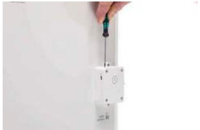
4. Utilisez le tournevis hexagonal pour desserrer les quatre boulons du boîtier du chargeur.
