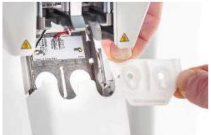
3. Insérez la languette centrale du capot de buse dans la fente du support de ventilateur de la tête d'impression. De l'intérieur de la tête d'impression, appliquez une pression sur la plaque métallique. En même temps, tirez la languette à travers le support et la plaque jusqu'à ce que le joint d'étanchéité verrouille le capot en place.
