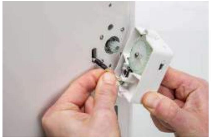
5. Utilisez une serviette propre ou un coton-tige pour essuyer toutes les particules de filament et les résidus de graisse présents sur les engrenages du chargeur. Nettoyez l'engrenage relié au moteur et l'engrenage plus grand situé à l'intérieur du chargeur.
