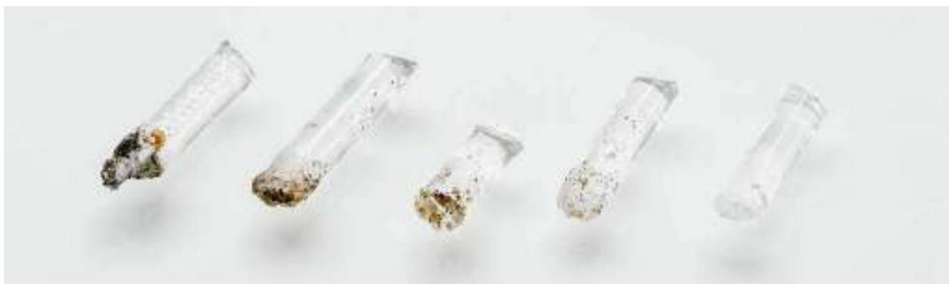
5. Répétez cette procédure jusqu'à ce qu'il n'y ait plus de matériau dégradé sur la pointe du filament de nettoyage. La pointe du filament doit avoir une apparence aussi propre que dans l'exemple à droite.
